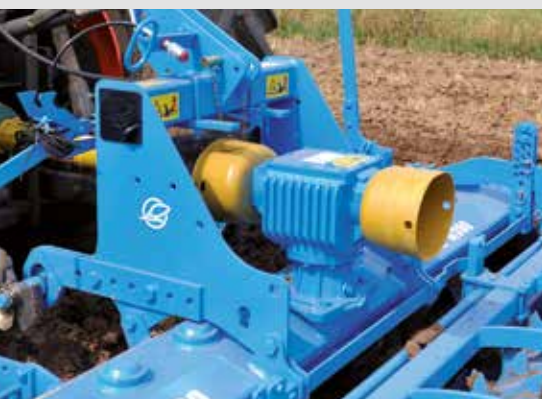
Проста передача зусилля через редуктор зі змінними шестірнями
