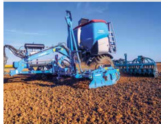
Рівномірний розподіл ваги з розвантаженням шасі
