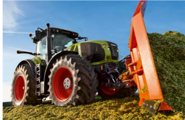
У комбінації з передньою навіскою спереду доступні до двох блоків управління подвійної дії та одна безнапірна зворотна магістраль. Ідеальний варіант для передньонавісного насіннєвого бункера або відвала.
