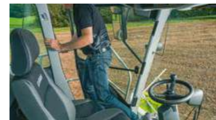
Датчик присутності на сидінні автоматично вимикає приставку й головний привод.
