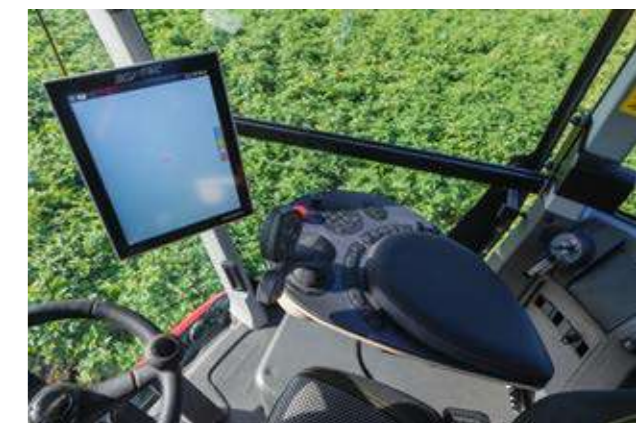
EcoTronicPlus в обприскувачах Condor Endurance: Ця система оснащена абсолютно новим, повністю інтегрованим підлокітником та джойстиком для простоти використання та підвищення продуктивності.
